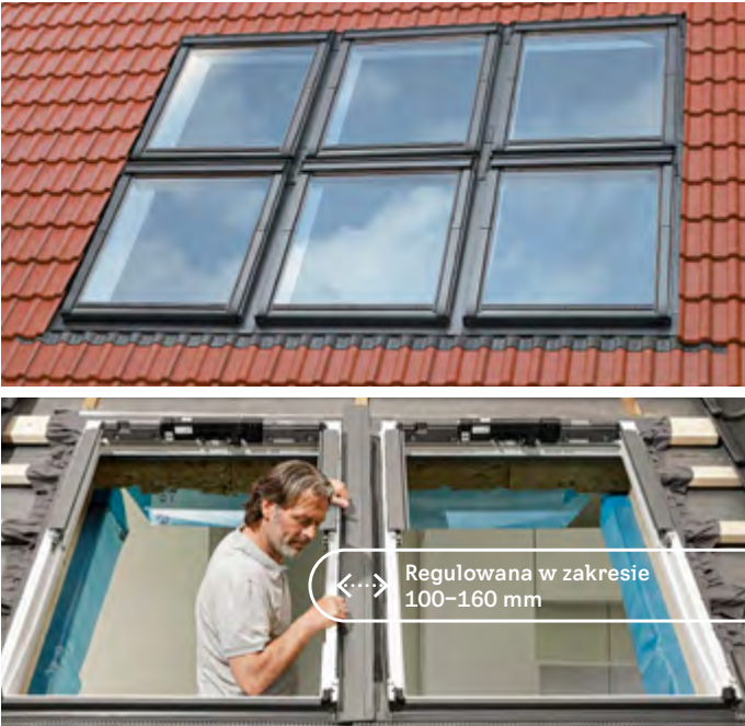
Zestawy z kołnierzami EKW, EKQ, EKX, EKS, EKL zawierają regulowaną rynną środkową, która umożliwia dopasowanie odstępów między oknami w zakresie 100-160 mm.
